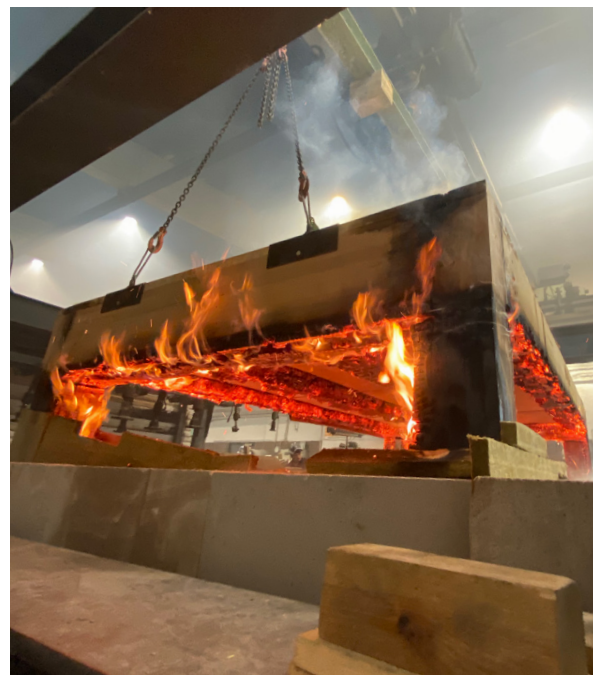
04 Lehm Holz Decke Brandversuch
